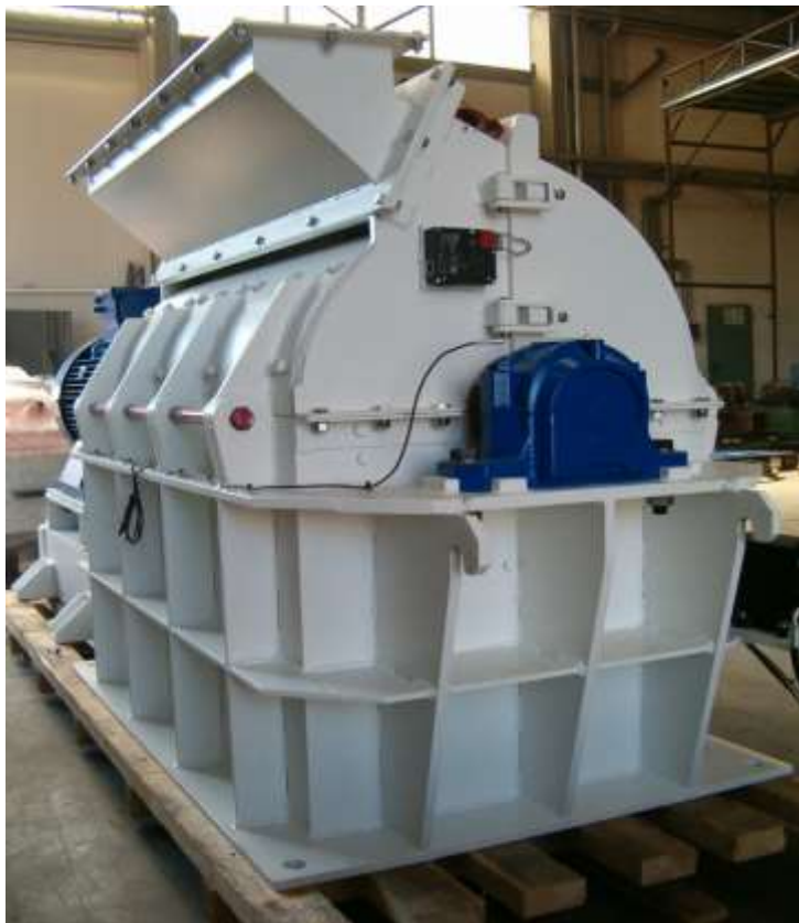
3. MOKRI MLIN ČEKIČAR "ZEPI srl" -za mokri čips - ROTOR fi 1000 L=1200 mm, motor 250 kW
