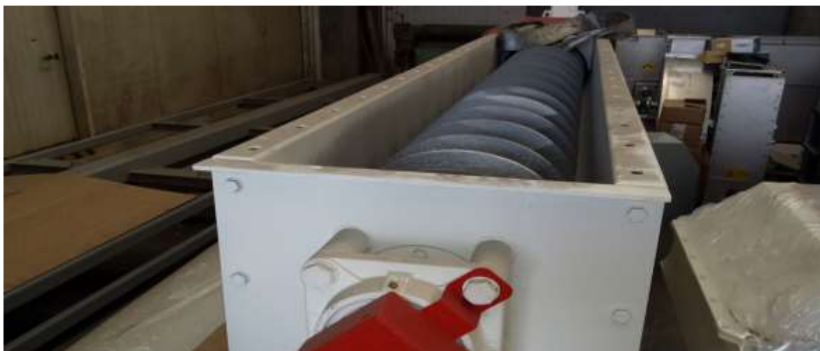
5. PUŽEVI ZA PRIJENOS ČIPSA RAZNI fi 400mm L=4000 mm, MOTOR 3 Kw
