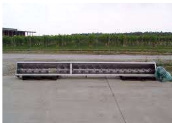
6. ROTACIONI MAGNETSKI ODVAJAČ U INOXU , motor 0,55 kW
